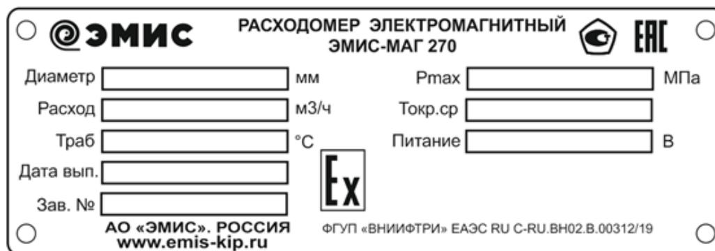
Рисунок 3 – Пример маркировочной таблички
